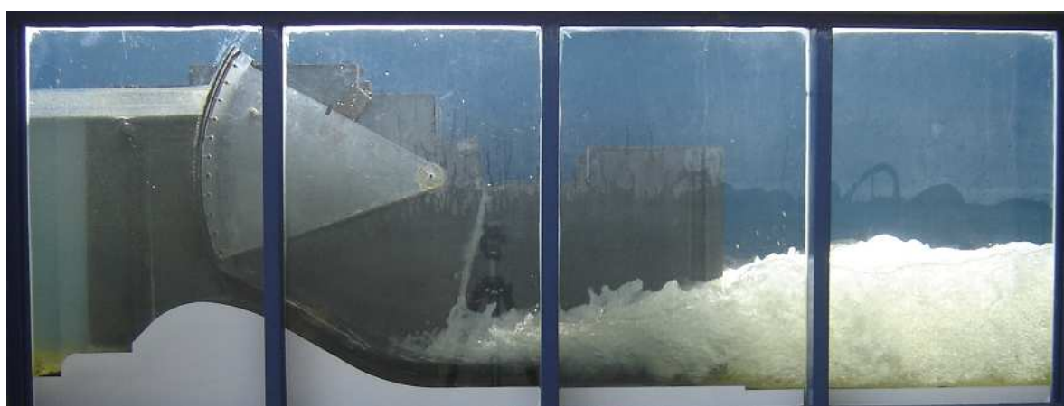
Figura 3.20: Situação 5; Vazão: 175 l/s; Fr_1 : 4,38; Y_1 : 0,05; Abertura Go : 0,09m.
