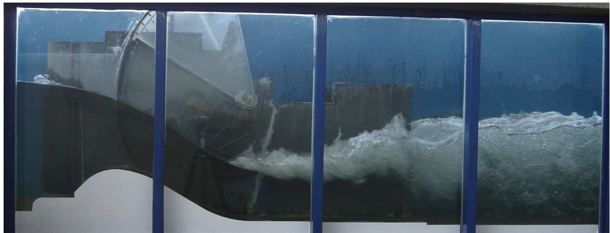
Figura 2.3: Ressalto hidráulico em modelo reduzido: vazão em 2,5 vãos de 444 l/s; Fr_1 : 1,70; Y_1 : 0,37m; abertura livre.
