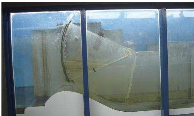
Figura 3.2: Modelo de detalhe do vertedouro da UHE Santo Antonio - escala 1:50. (vista lateral).
