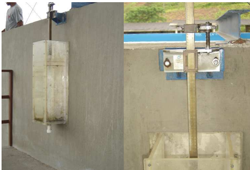
Figura 3.9: Régua linimétrica e poço de medição usados neste estudo.
