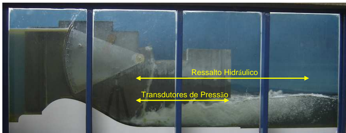
Figura 4.6: Situação 7; Vazão 70 l/s; Fr_1: 7,73 ; Y_1: 0,02m Abertura G_0: 0,03m , comprimento sugerido do ressalto hidráulico.
