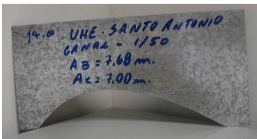
Figura 3.12: Gabarito metálico para imposição de abertura parcial.
