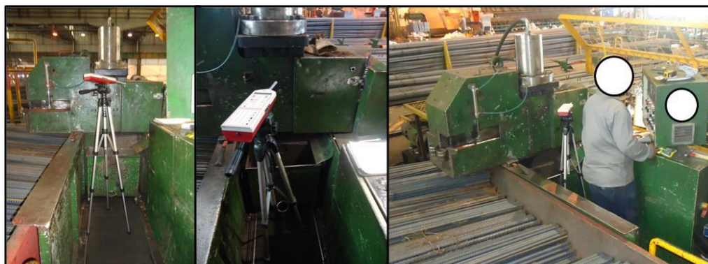
Figura 3.7 - Posicionamento do decibelímetro.
