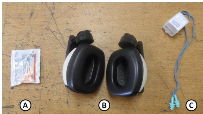
Figura 3.4 - Protetores auriculares, a) protetor de inserção moldável, b) protetor concha, c) protetor inserção pré-moldado.
