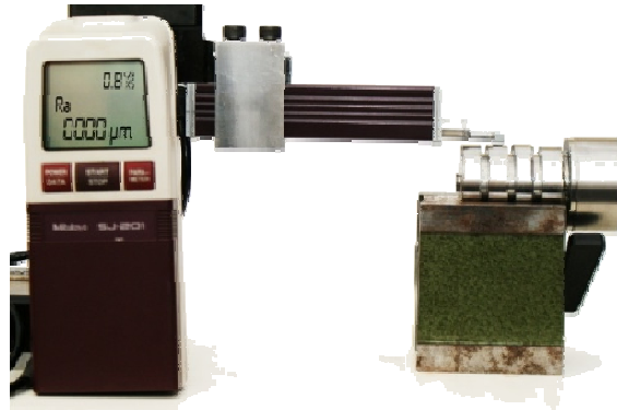
Figura 4.8 – Equipamento para medição de rugosidade: Rugosímetro Mitutoyo modelo SJ-201.
