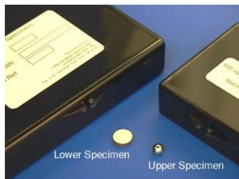
Figura 4 - Corpo de prova e contra-corpo utilizados no ensaio HFRR
