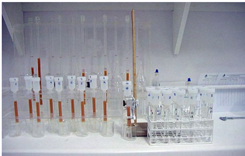
FIGURA 3.4 – Colunas catiônicas e de “pó de teflon” do LGI-UFRGS, respectivamente.
