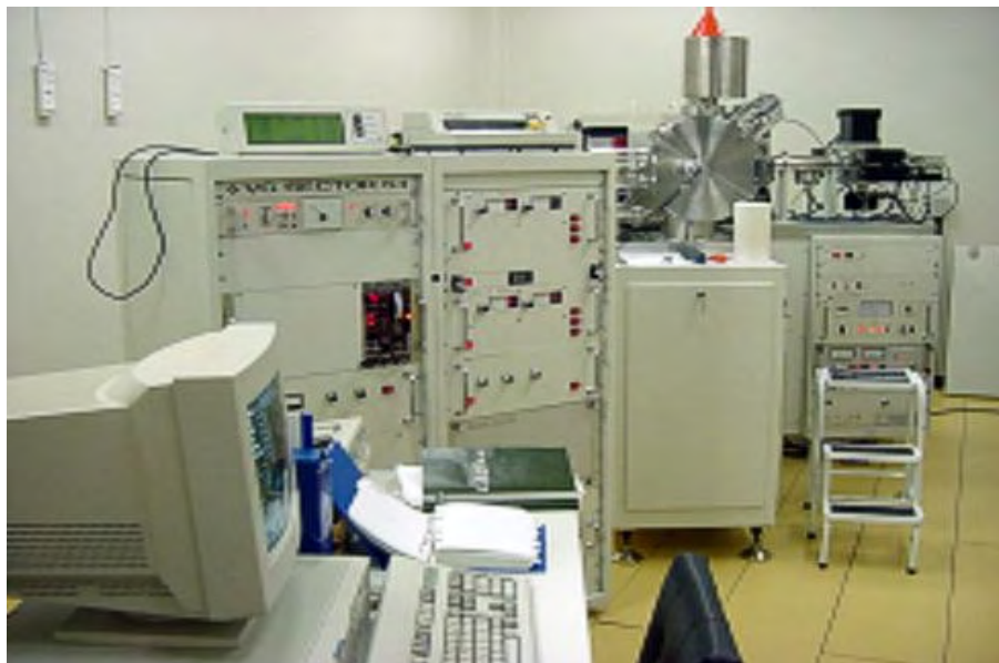
FIGURA 3.2 - Espectrômetro de massas VG Sector 54 do LGI-UFRGS
