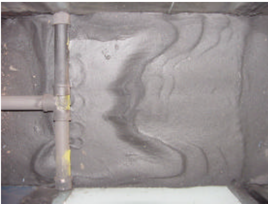
Figura 6.4: Imagem em planta de depósito gerado no ensaio 1 com emprego de difusor de 6 orifícios.
