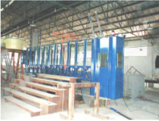
Figura 5.1: Canal bidimensional de geometria simplificada na configuração original.
