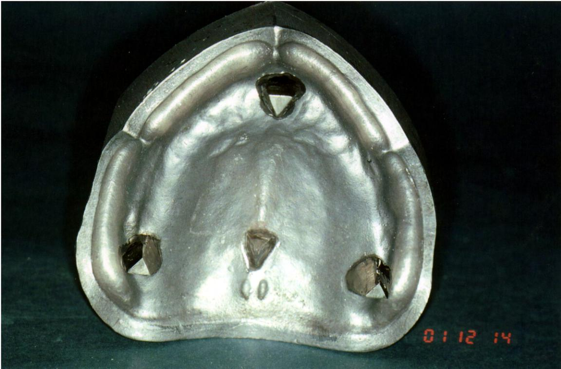
FIGURA 1 – Modelo-padrão metálico com as referências para medições
