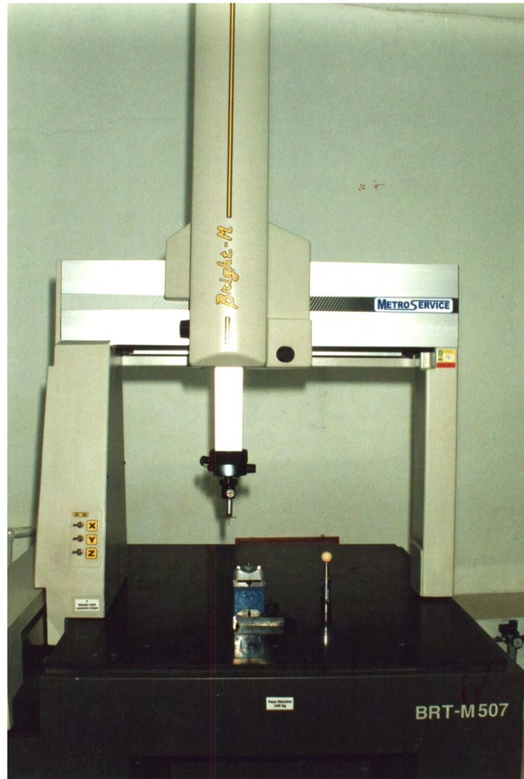
FIGURA 10 – Fotografia mostrando o braço de medição e o modelo a ser aferido, no centro do aparelho
