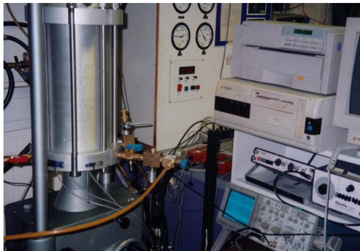
Figura 35. Detalhe do equipamento utilizado na medição do módulo cisalhante inicial
