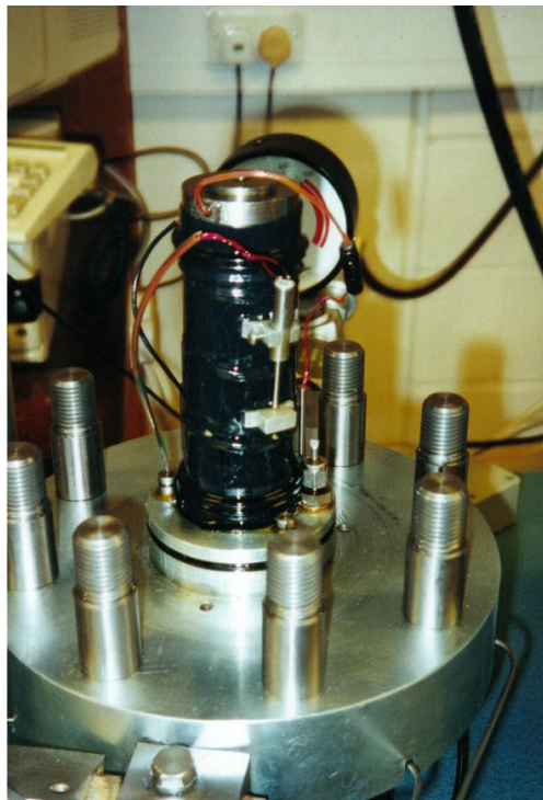
Figura 33. Detalhe da instrumentação local utilizada nos ensaios de compressão isotrópica
