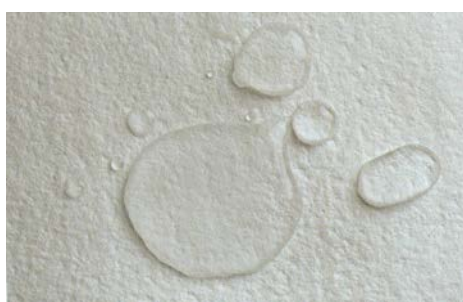
Figura 3 - a cola dá impermeabilidade ao papel
