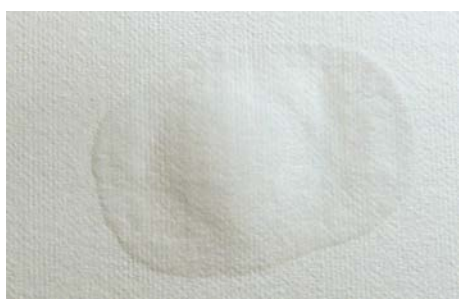
Figura 2 - o papel sem cola absorve a água
