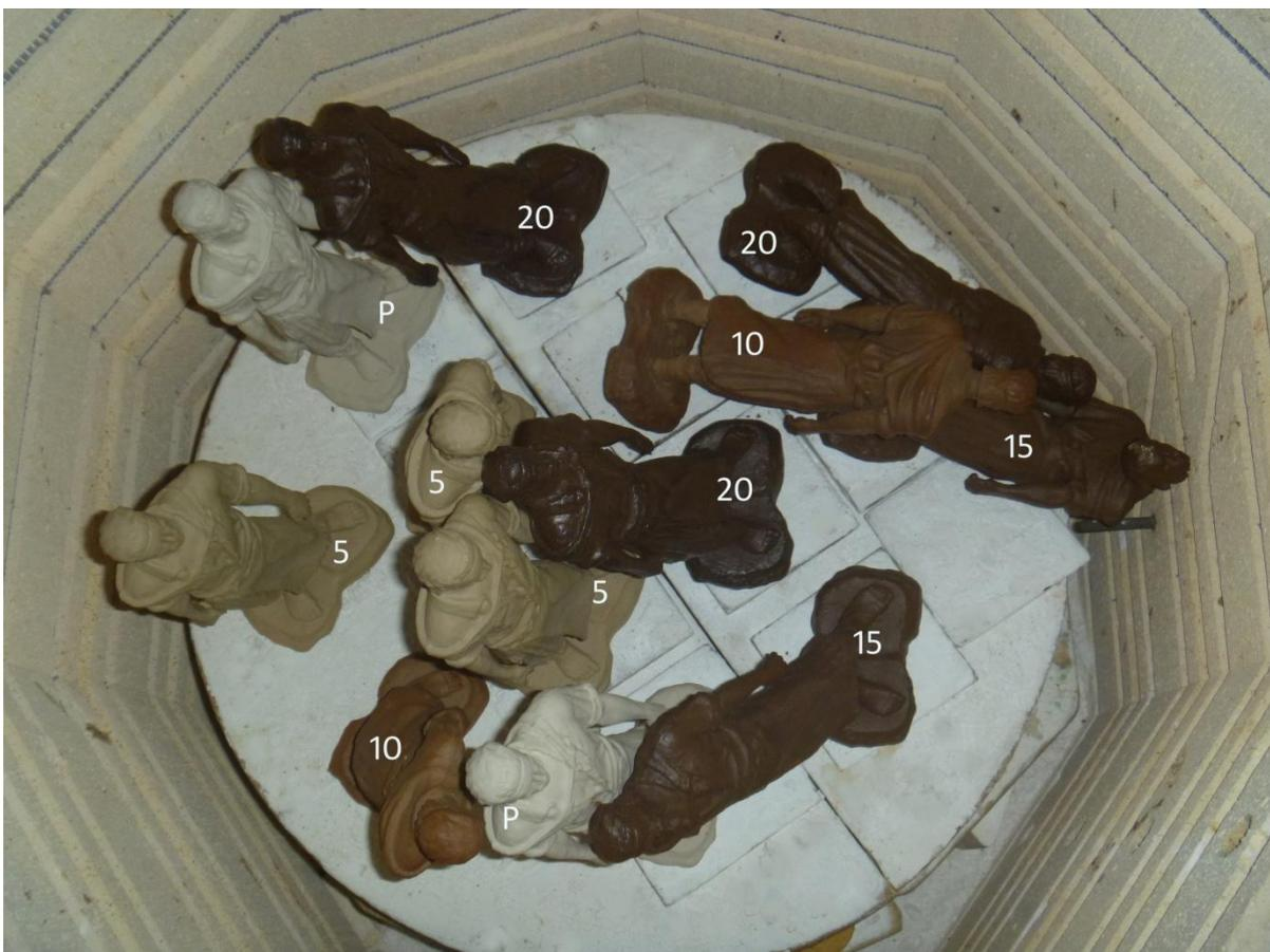
A Figura 81 mostra um exemplar de cada barbotina sinterizada a 1220°C. As peças fundidas com a porcelana Biscuit Volpetiz não apresentaram deformação, resultado esperado visto que esta barbotina era sinterizada a 1280°C na antiga fábrica Biscuit Volpetiz. Observa-se também que as peças fundidas com barbotinas incorporadas com o resíduo pó de aciaria apresentaram deformações proporcionais à concentração do resíduo, fato que indica a ação fundente do referido resíduo.
