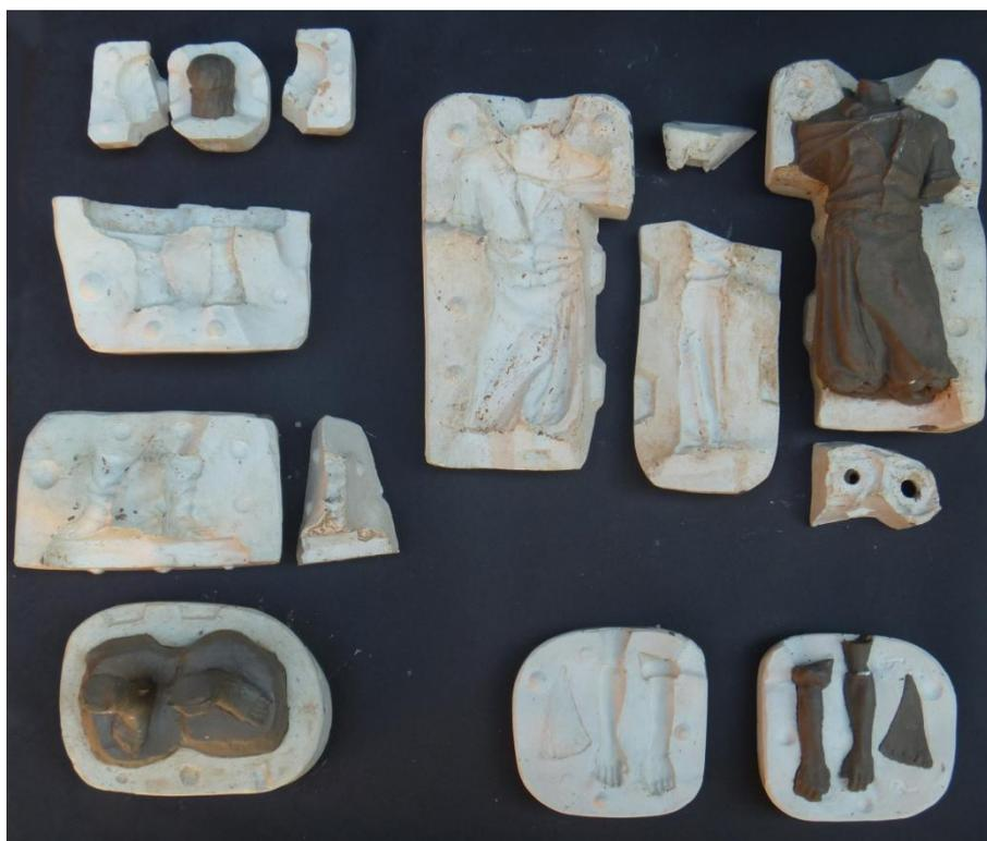
A Figura 65 mostra os 4 taceos referentes à base e as pernas da estatueta. Posteriormente, constatou-se que esta parte deve ser fundida de forma maciça (sem retirada do excesso de barbotina) na noite anterior para que, tendo tempo suficiente para secar e endurecer, suporte o peso das demais partes do corpo no dia seguinte.
