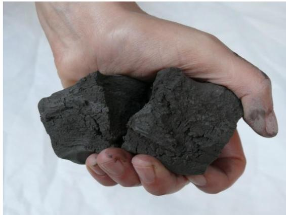
O pó de aciaria apresentava-se na forma de pó com coloração marrom escuro, sendo submetido à secagem em estufa a 80°C por 24 h e então peneirado em malha 80 (abertura de 180 µm) (Figura 38. b).
