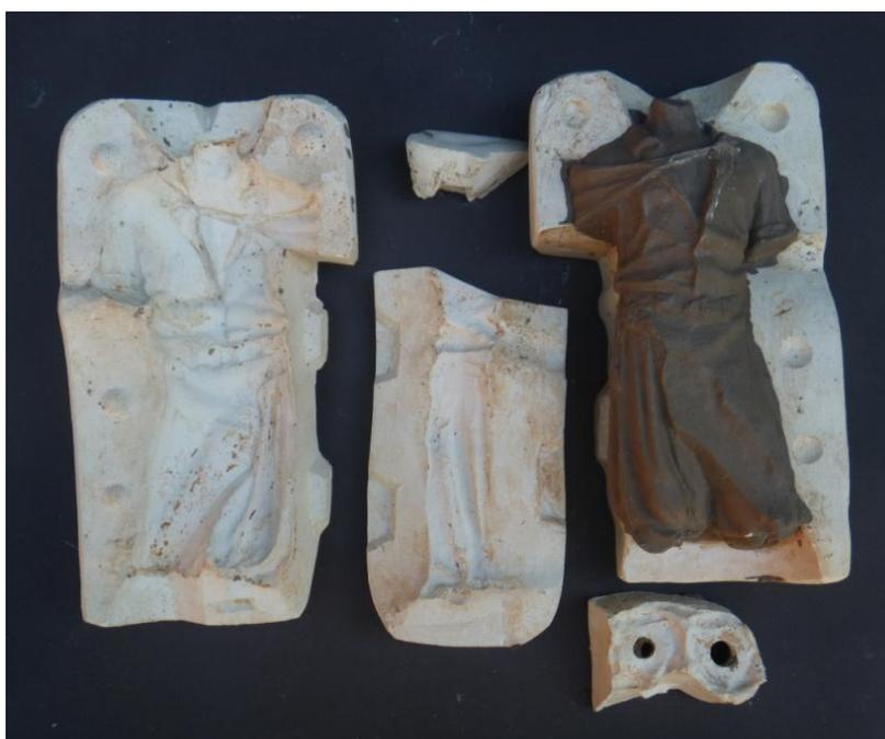
A Figura 69 mostra a abertura dos 3 tacelos referentes à cabeça e a Figura 70 mostra a abertura dos 2 tacelos referentes aos antebraços e à ponta do tirador da estatueta *O Laçador*.
