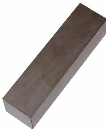
Figura 47 Bloco de 1P Somaloy 500 medindo 30mm x 30mm x 115mm.
