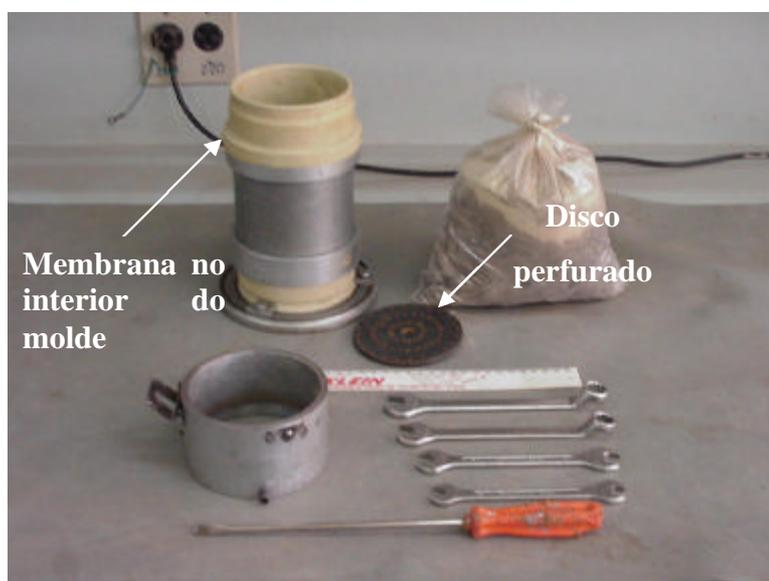
**Figura 3.5** – Equipamentos para a moldagem dos CPs
