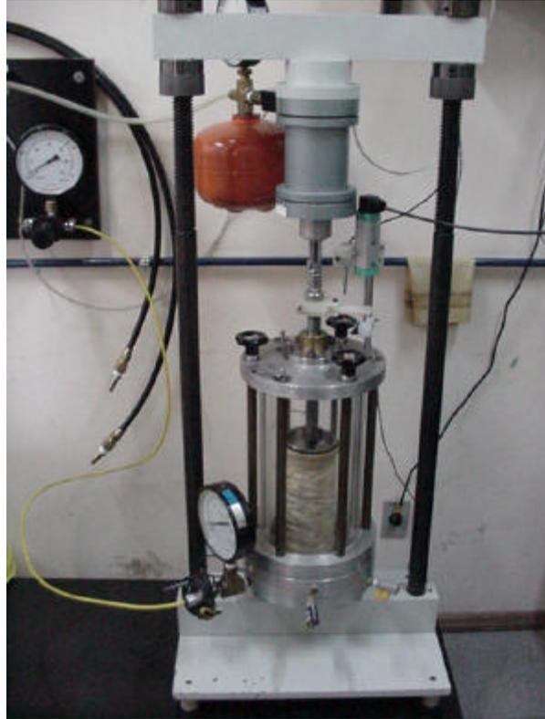
**Figura 3.9** – Equipamento triaxial para cargas repetidas
