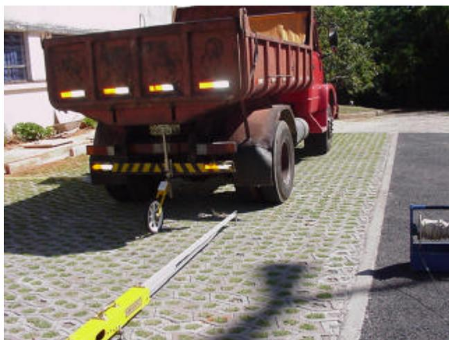
**Figura 3.19** – Equipamentos para os levantamentos deflectométricos
