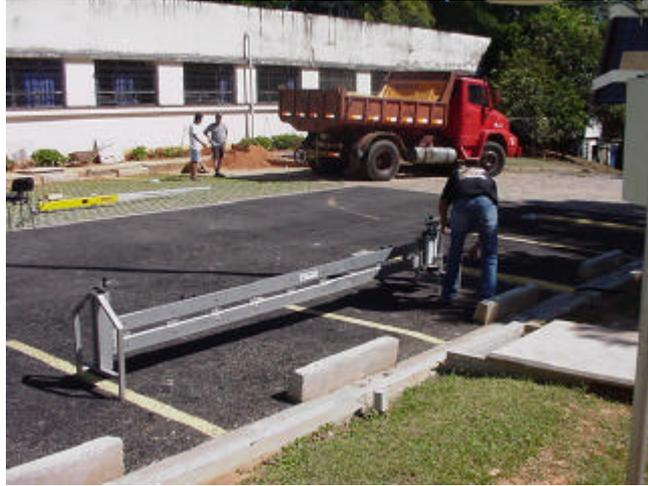
**Figura 3.20** – Determinação do perfil com transverso-perfilógrafo
