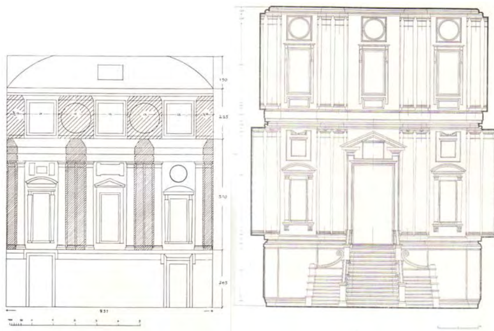
Figura 50 – Reconstituição do projeto inicial para a parede da face leste do Ricetto, com a abóbada prevista para a cobertura, realizada por Rudolf Wittkower (WITTKOWER, 1979, p. 385) e desenho da parede conforme executada na face oeste do Ricetto (SCHIAVO, 1949, fig. 28).
