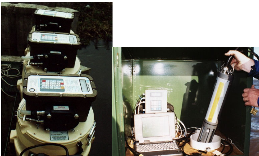
Figura 4.2 - Autoamostradores ISCO®, Sonda Yelow Spring® e estação de dados meteorológicos.
