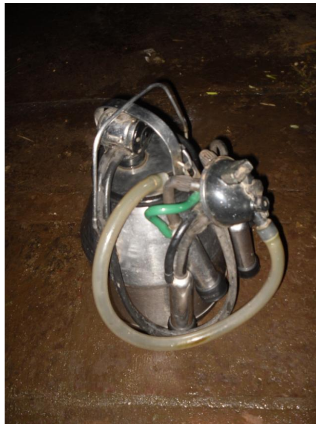
Figura 7 - Conjunto de ordenha do tipo balde ao pé para ordenha de vacas recém-paridas, mastíticas e em descarte de leite
