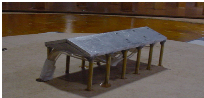
Figura 11: modelo 3 com tomadas de pressão externa
