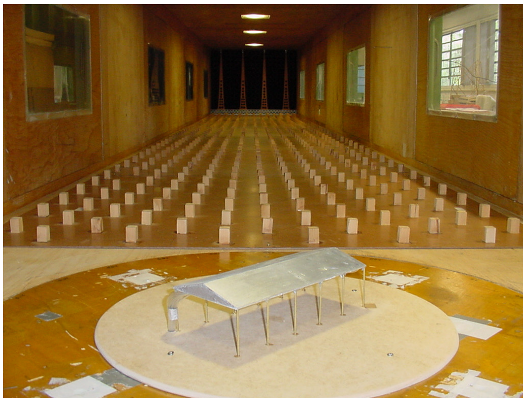
Figura 12: modelo 2 com tomadas de pressão externa e simuladores de rugosidade do terreno
