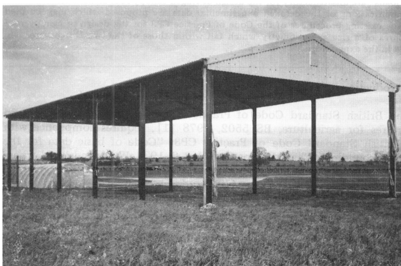
Figura 4: protótipo utilizado nos ensaios de Robertson, Hoxey e Moran (1985)
