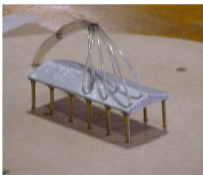
Figura 75: modelo 3 (escala 1:300 e e = 2,0mm ), com tomadas de pressão interna
