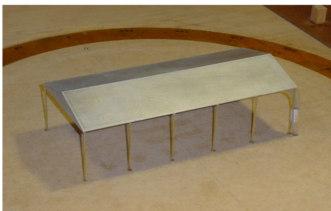
Figura 13: modelo 1 com tomadas de pressão externa
