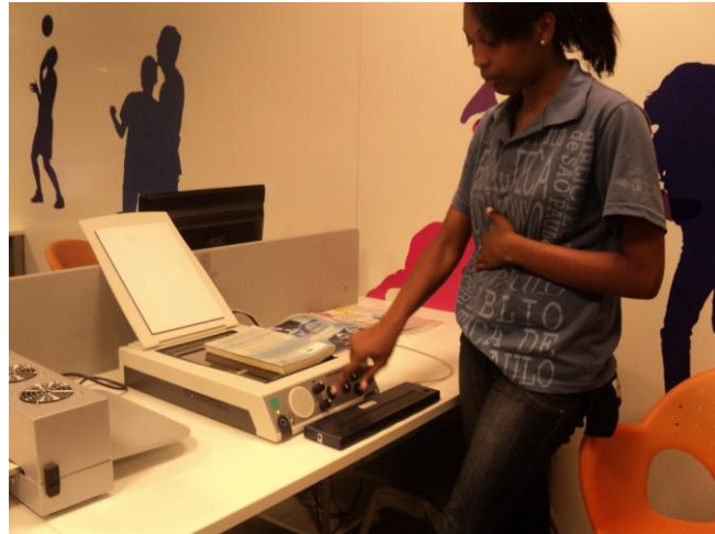
Equipamento com sistema de scanner, saída de voz e teclado em Braille
