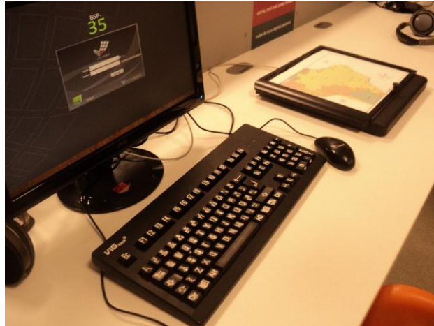
Computador equipado com leitor de tela e teclado com fonte aumentada
