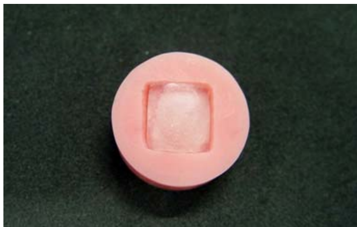
Figura 3. Corpo de prova de resina acrílica fixado à base de resina acrílica rosa.
