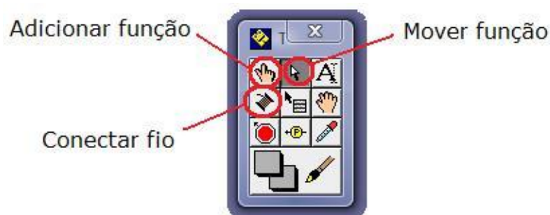
Figura 21 Paleta de ferramentas do programa com as que seriam utilizadas destacadas e identificadas
