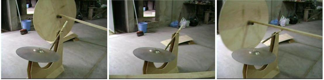
Construí também um instrumento de cordas que é tocado por uma palheta presa a uma pequena alavanca dotada de uma mola. Ao passar por este aparelho, a grande roda desloca a alavanca, fazendo com que as cordas soem.
