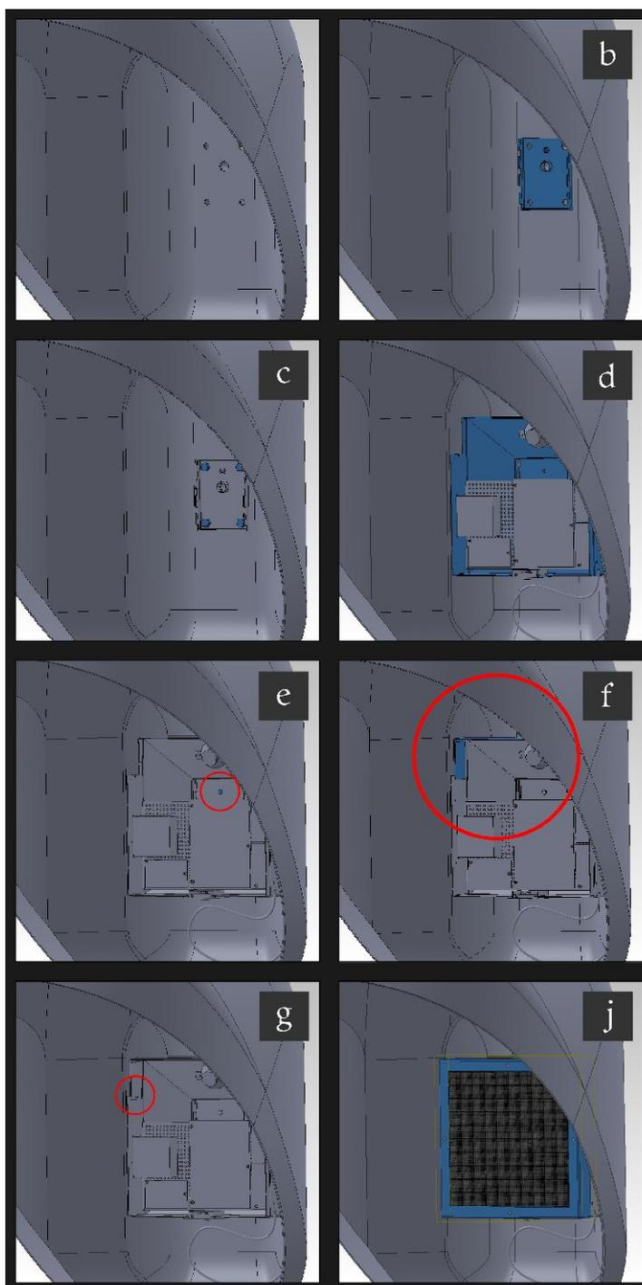
Figura 54: Alguns passos do processo de instalação do CHU 2836 no Orelhão.
