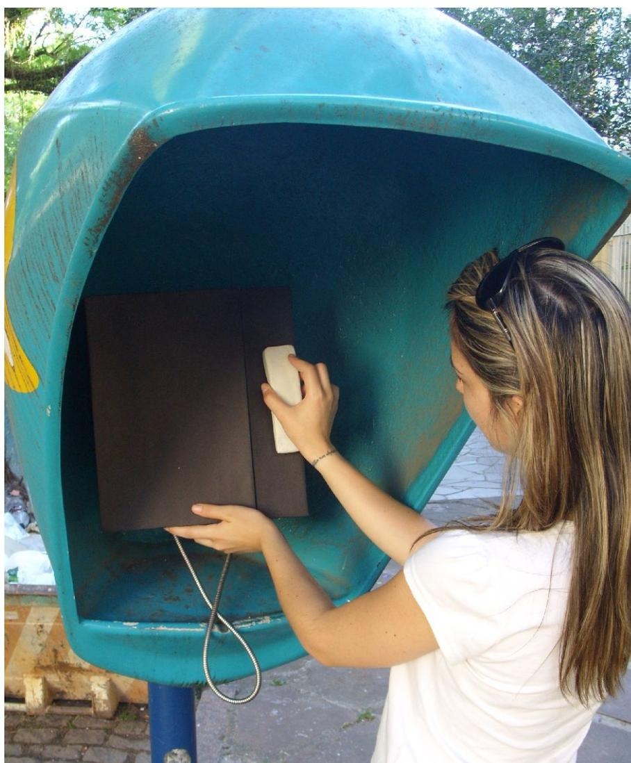
Figura 55: Validação das dimensões do dispositivo feita com uma modelo simples em papel disposto em um Orelhão.
