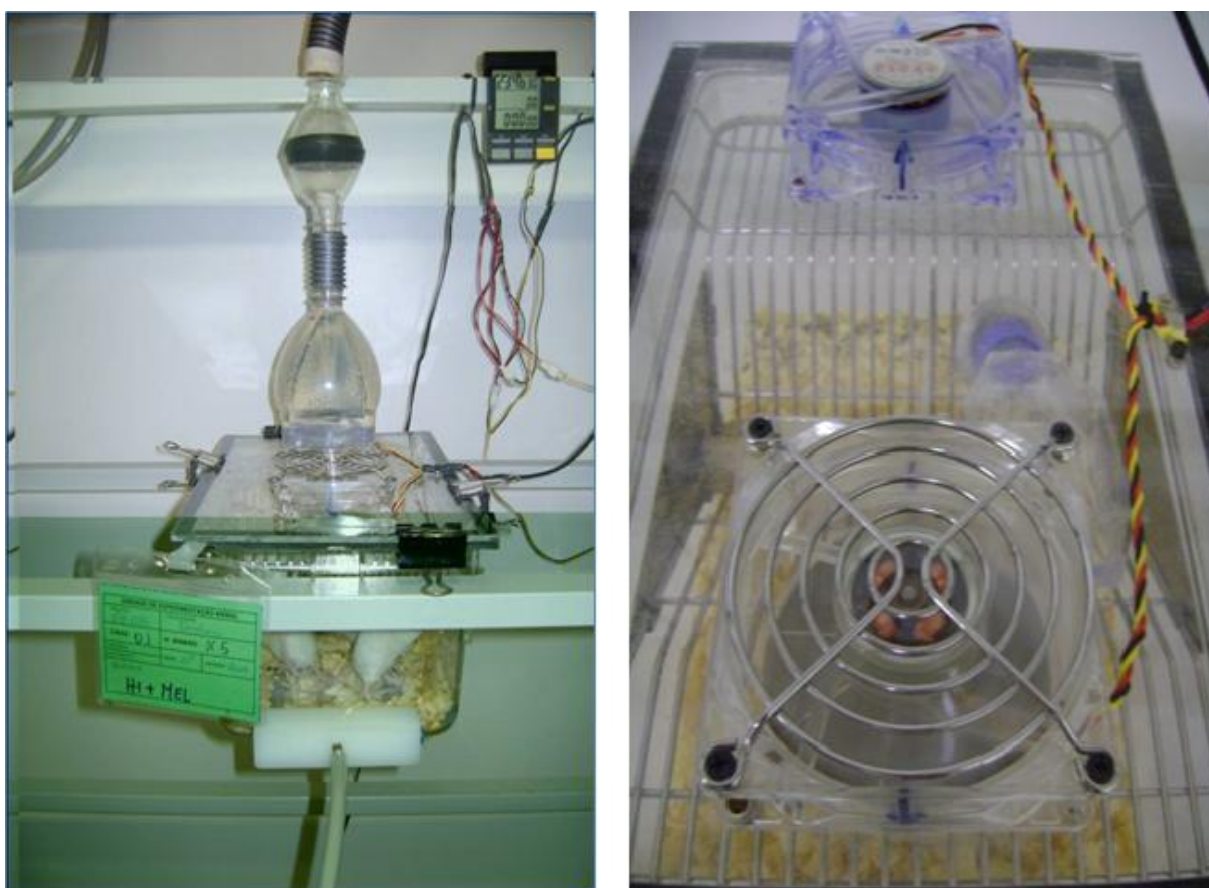
Figura 13 - Visão externa da câmara de hipóxia intermitente (HI), à esquerda, e da câmara de normóxia (HIS), à direita. O sistema pode ser comparado com o diagrama mostrado na figura anterior.
