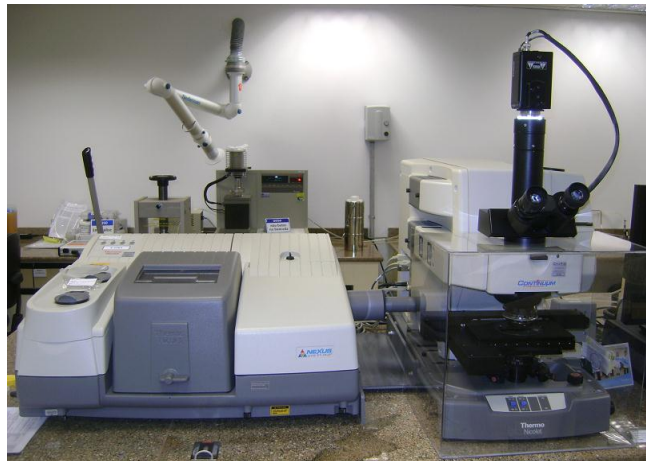
Figura 14 - Espectrofotômetro de Infravermelho por Transformada de Fourier marca Thermo Nicolet modelo Nexus 470
