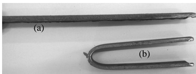
Figura 3.21 Ensaio de dobramento. (a) Perfil da amostra antes da dobra, (b) perfil da amostra dobrada em ângulo de 180°
