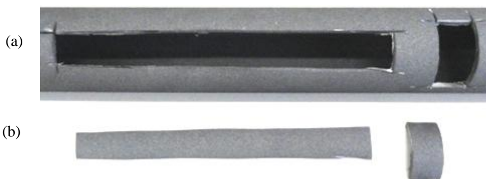
Figura 3.8 Amostras aspergidas. (a) Tubo aspergido recortado, (b) Corpos de provas recortados do tubo
