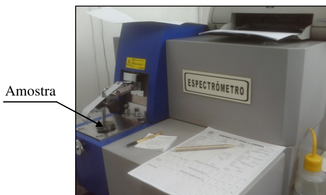
Figura 3.1 Espectrômetro utilizado para análise química do material base (substrato).
