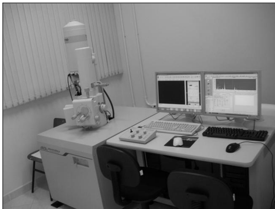
Figura 3.11 Microscópio Eletrônico de Varredura utilizado na caracterização do ensaio de desgaste.
