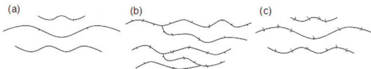
**Figura 3.** Esquema de diferentes classes de polietileno. (a) polietileno de alta densidade, (b) polietileno de baixa densidade, (c) polietileno linear de baixa densidade-[5].
