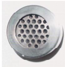
**Figura 10.** Imagem de uma placa perfurada. Fonte: Polígrafo de Extrusão do IFSUL Rio- Grandense – Campus de Sapucaia do Sul.
