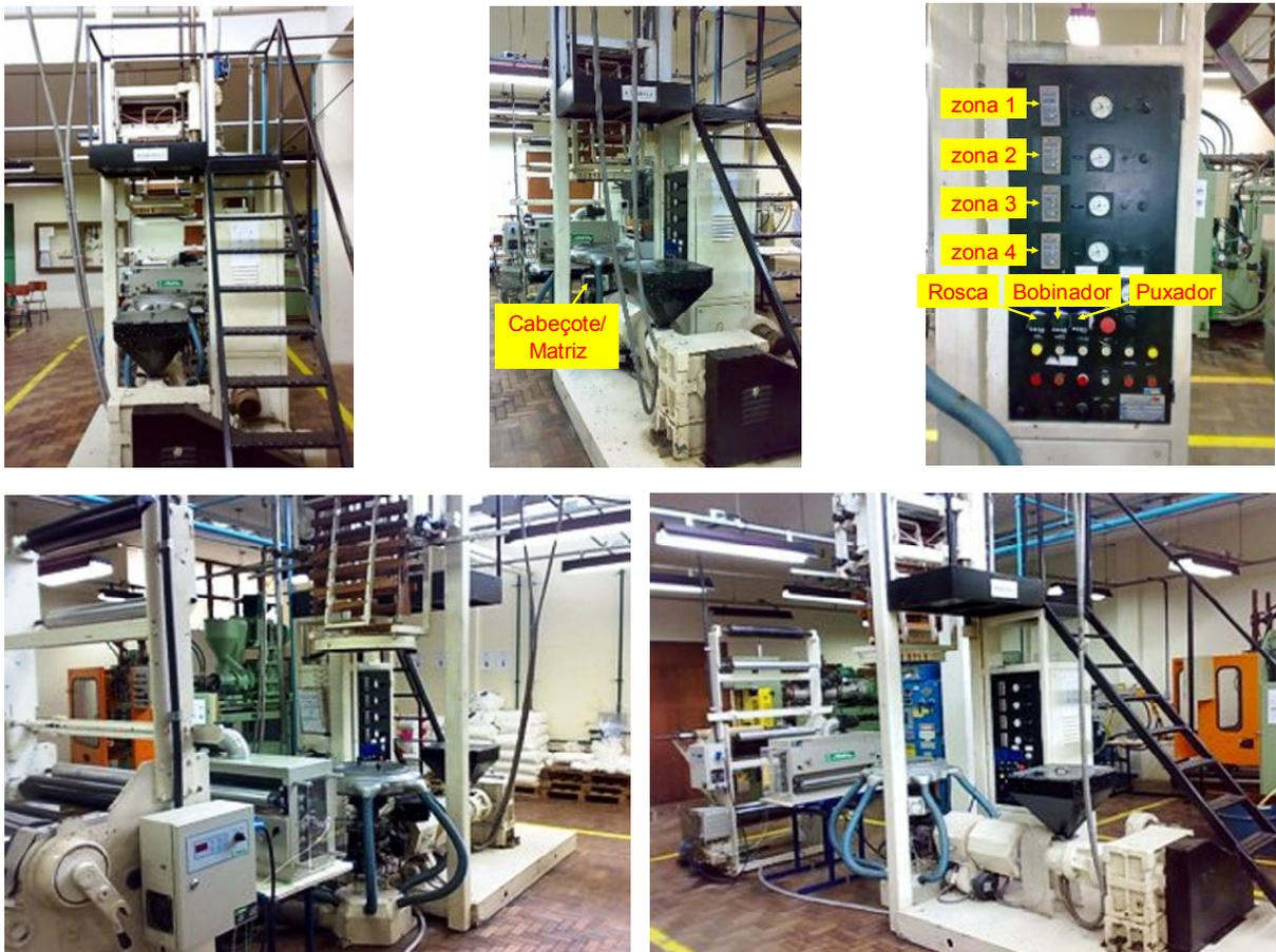
**Figura 28.** Linha de extrusão utilizada no estudo: marca Carnevalli, modelo B700, Série B, ano 1985.
