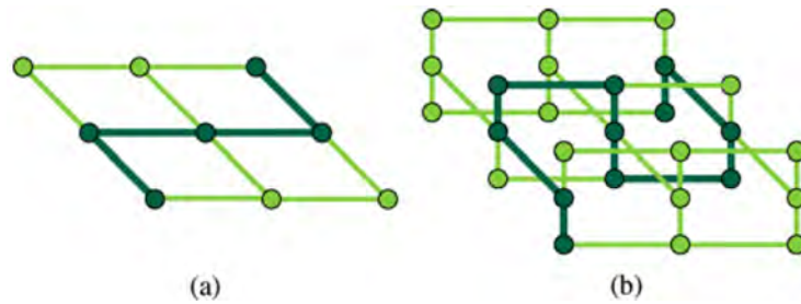
Figura 3.46: Roteamento monotônico normal e monotônico aéreo. (HSU; CHEN; CHANG, 2010).
