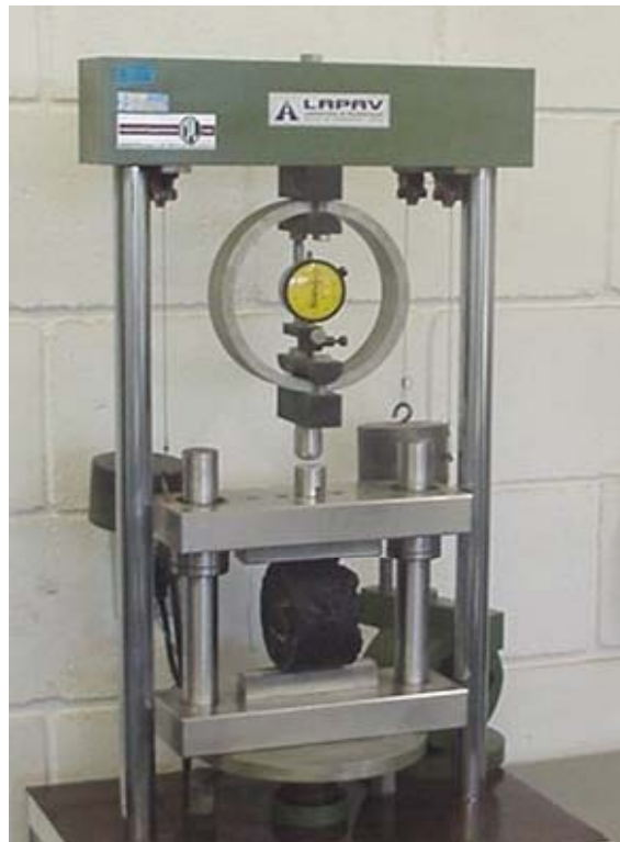
Figura 3.12: Equipamento para ensaio de resistência à tração em materiais cimentados e misturas asfálticas.
