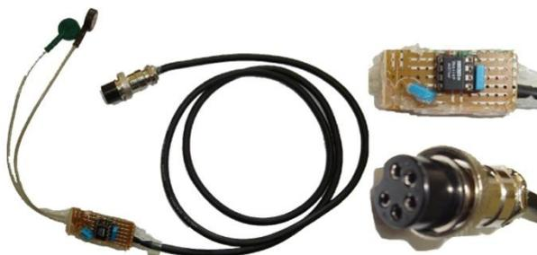
**Figura 23 Cabo pré-amplificado desenvolvido (BALBINOT, 2006).**
