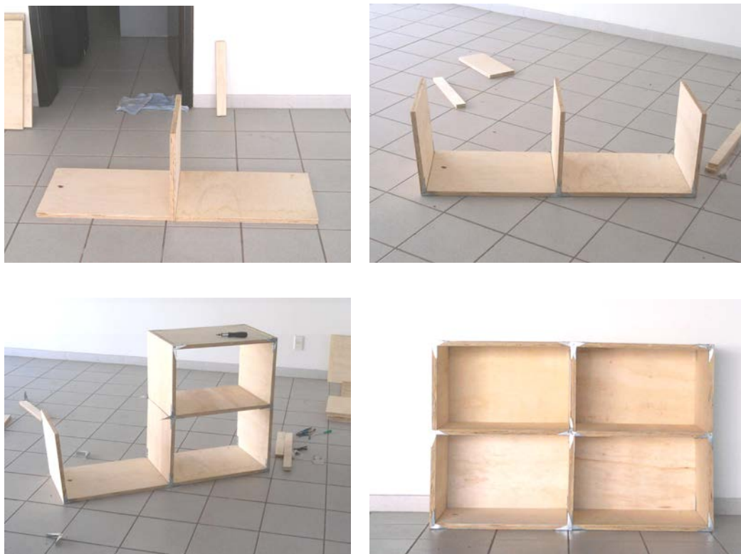
Fig. 51 Segundo processo de montagem e estante finalizada.
