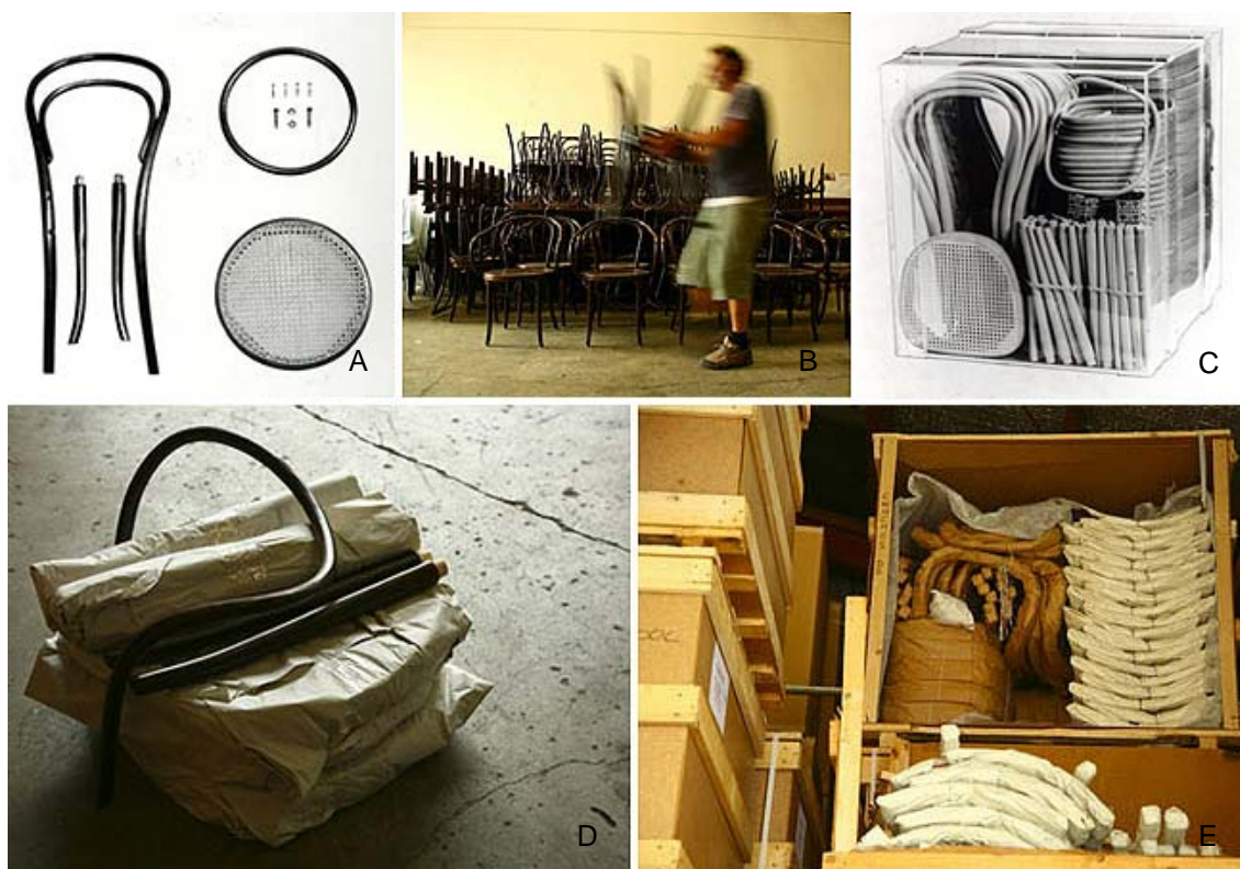
Fig. 2 - Etapas do processo de montagem da Thonet 214. a) peças da cadeira; b) cadeiras montadas e empilhadas; c) conjunto de cadeiras desmontadas prontas para o transporte; d) pacote contendo uma cadeira desmontada; e) caixa contendo cadeiras desmontadas. Fonte: http://www.thonet.com/ .
