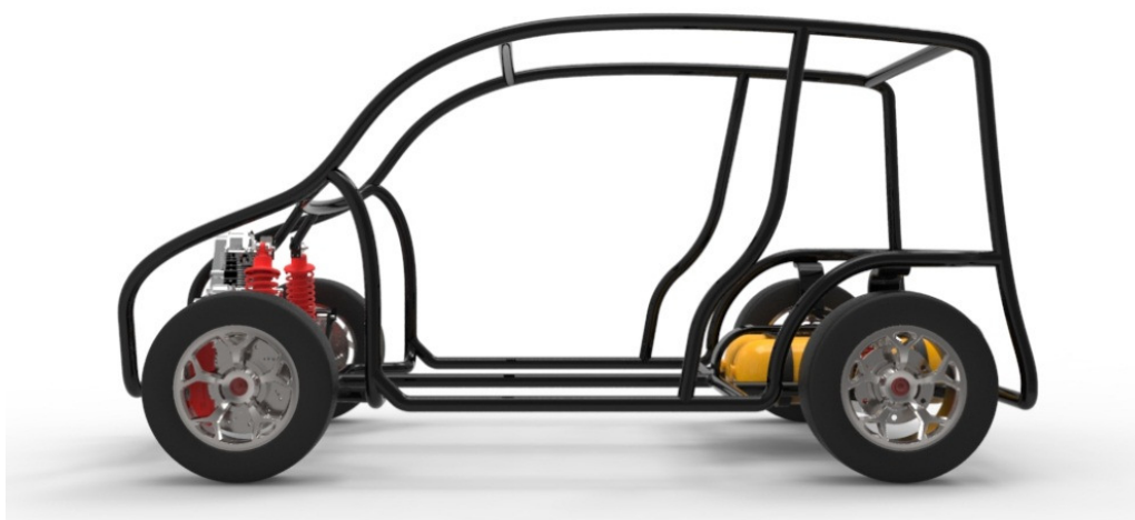
Figura 50 - Estrutura tubular, vista lateral
