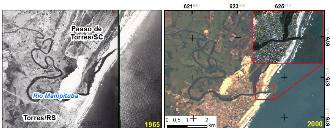
Figura 4 – A diminuição da faixa de praia no Município de Passo de Torres/SC resulta da construção de infraestrutura costeira que alterou a dinâmica costeira (↑ N) .
