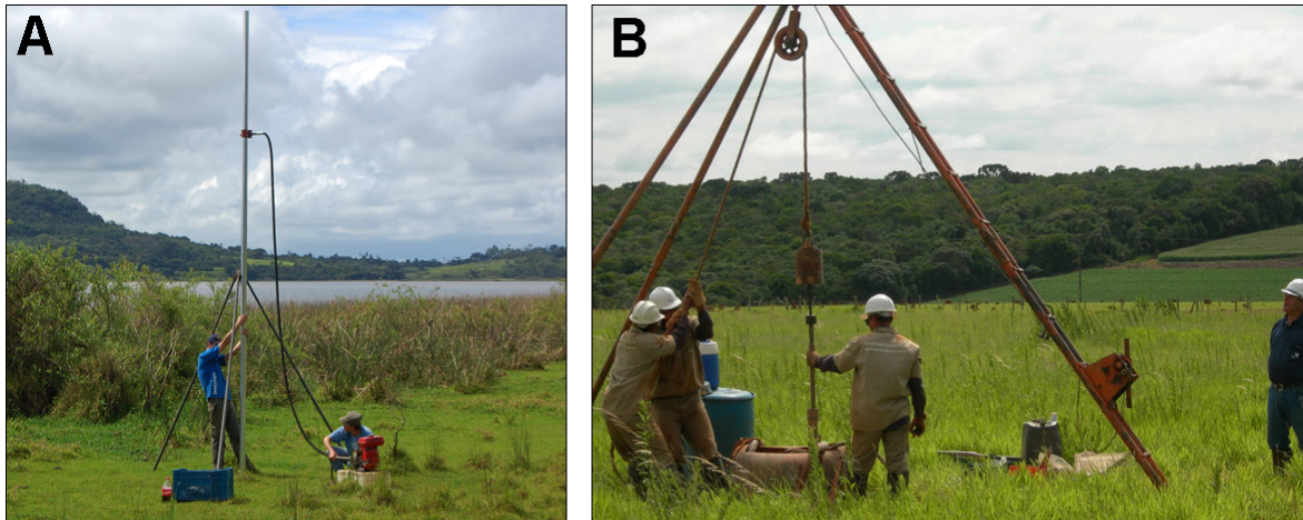
Figura 6: Tipos de sondagens utilizadas A) Sondagem tipo VIBROCORE; B) Sondagem tipo SPT.
