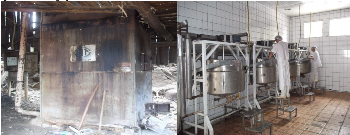
Figura 16: Exemplos de adequações de máquinas na Agroindústria Strack Alimentos Naturais: à direita os tachos de cozimento a vapor e à esquerda a caldeira adaptada à queima do bagaço da cana.
