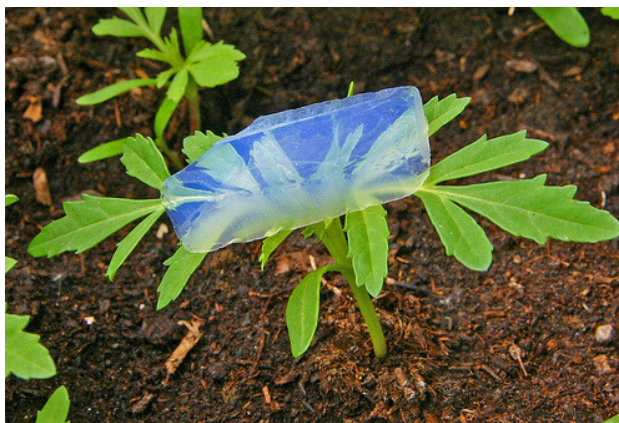
Fig. 3.4: Foto de um bloco de aerogel sobre uma planta mostrando o quanto o material é leve.
