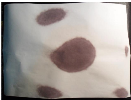
Figura 58. Padrão de ondas estacionárias do forno de microondas no papel térmico de fax.
