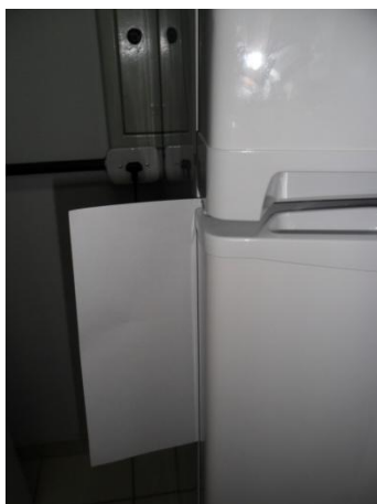
Figura 21. Teste de vedação da porta da geladeira.
