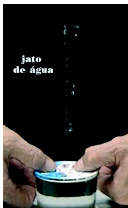
Figura 34. Jato produzido pela rápida compressão na tampa 38 .
