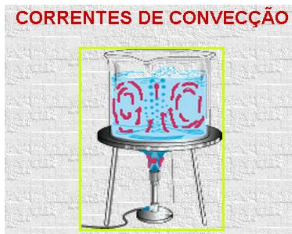
Figura 23. Simulação de correntes de convecção. 29
