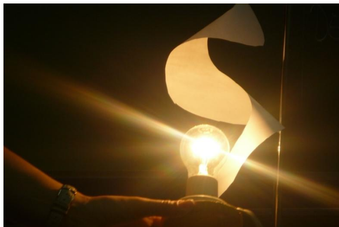
Figura 25. Correntes de convecção do ar giram helicóide.
