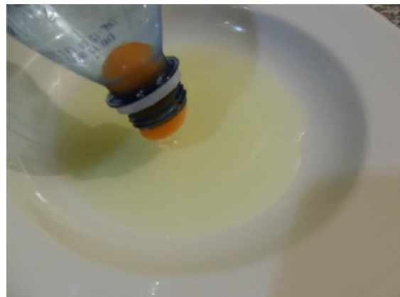
Figura 33. Separação da gema do ovo por diferença de pressão.
