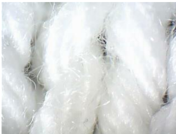
Figura 20. - Tecido de lã ampliado 20 vezes. 27
