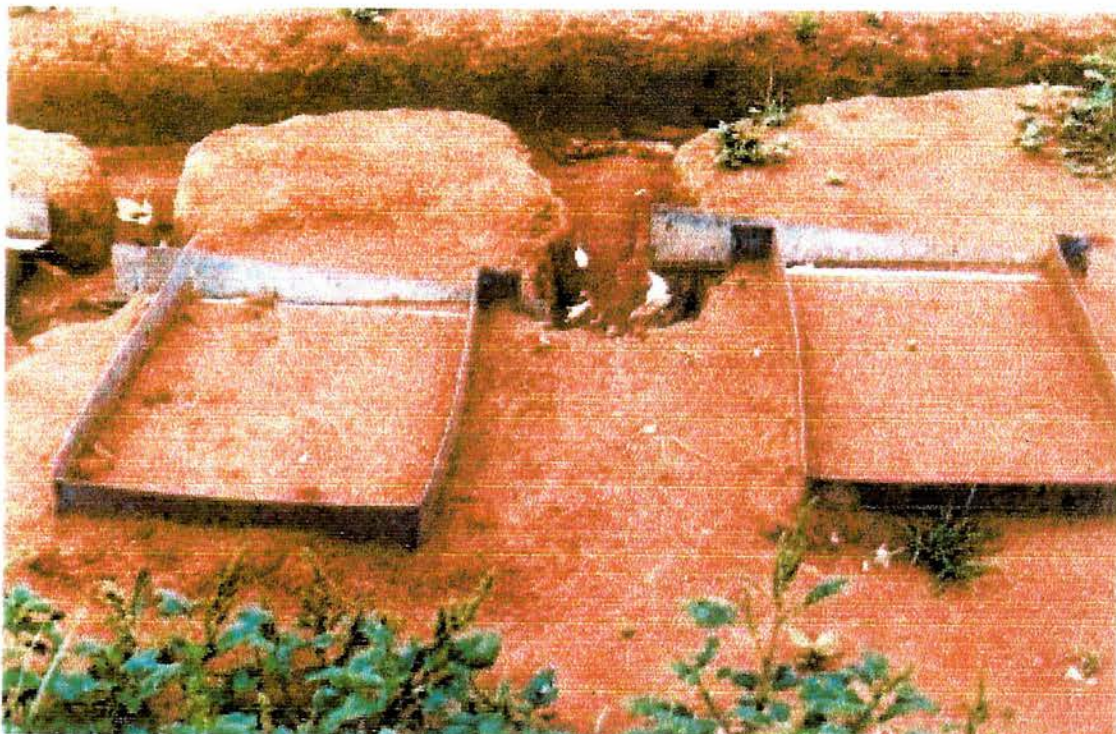
Figura 3.2 – Parcelas experimentais para estudo da erosão em entressulcos em condições de campo.
