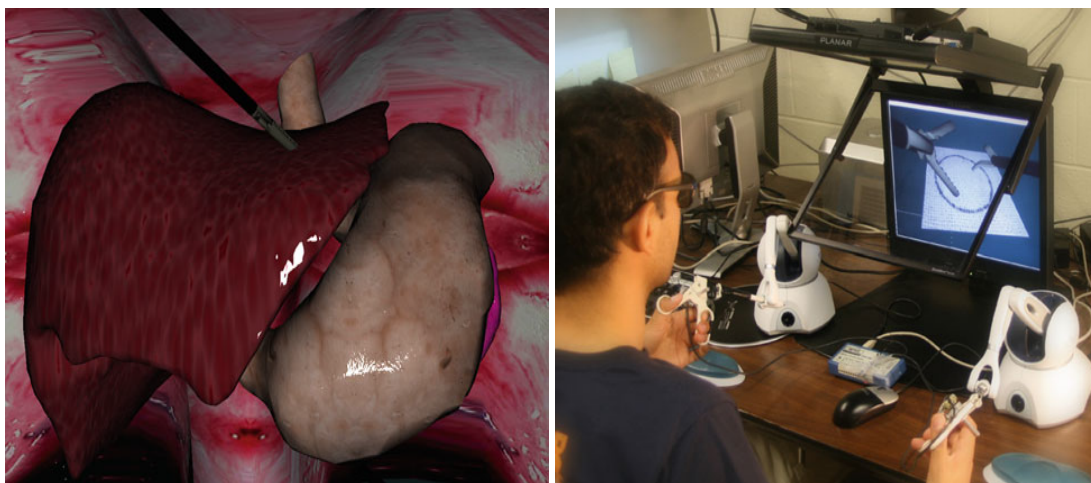
Figura 1.2: Na figura da esquerda, o framework de simulação de cirurgia em funcionamento, renderizando os órgãos internos de um paciente. Na figura da direita, está sendo mostrada a interação háptica através do Phantom (MACIEL et al., 2010).
