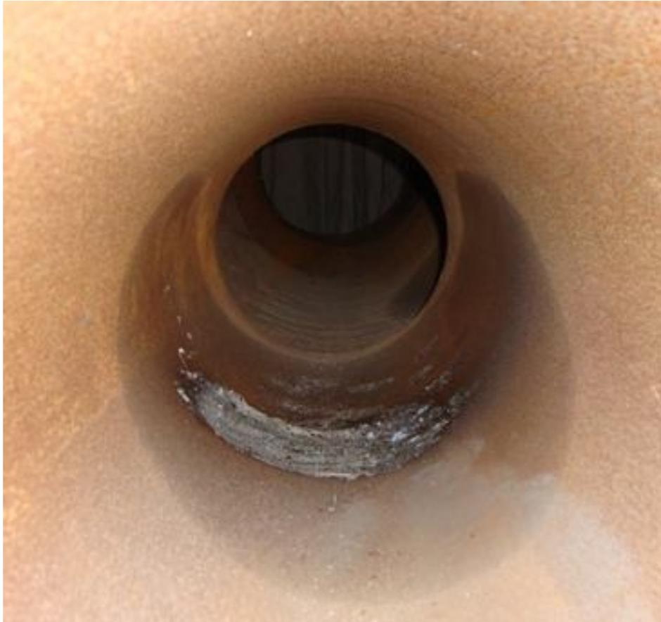
Figura 42 – Defeito em forma de corrosão generalizada simulado na região interna do duto.
