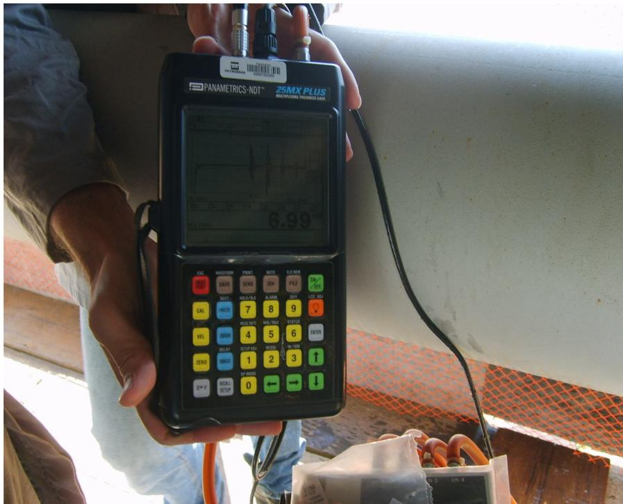
Figura 30 - Aparelho de ultrassom utilizado
