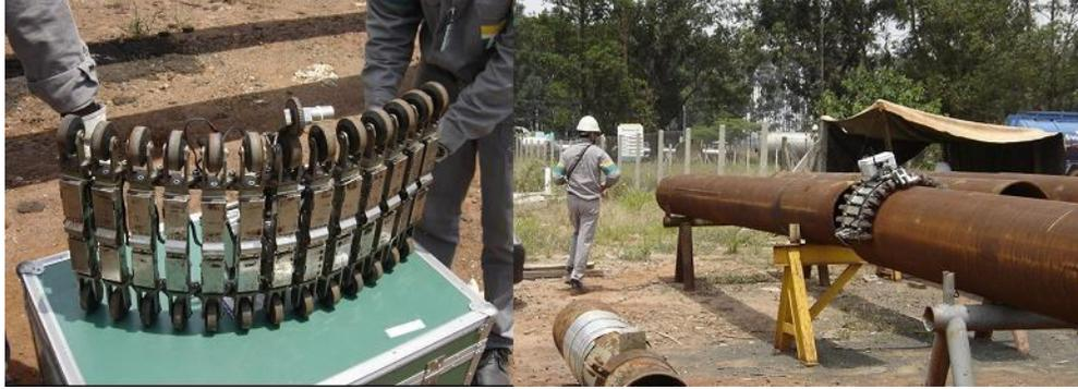
Figura 21 – Sistema de inspeção externa de tubulações GIP.
