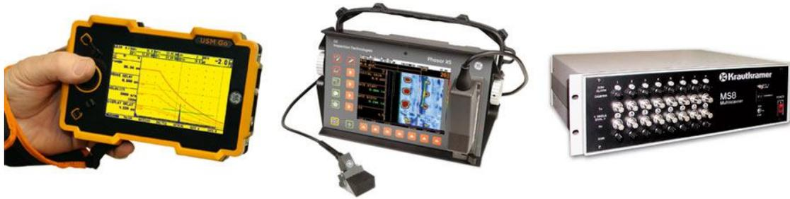
Figura 13 - Aparelhos de ultrassom comerciais e *multiplexer* para diversos canais simultâneos
