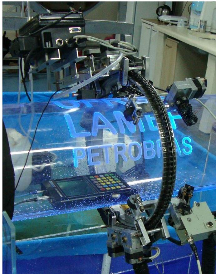
Figura 31 – Duto de demonstração em acrílico com o robô de Inspeção de Dutos montado. Repare nas palavras “UFRGS” no topo, “LAMEF” no centro e “PETROBRAS” na parte inferior da imagem: estas palavras estão usinadas na face interna do duto em diferentes profundidades.
