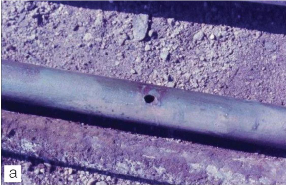
Figura 5 - Corrosão eletrolítica em tubos de aço-carbono provocada por corrente de fuga em parte de um equipamento (Merçon 2004)
