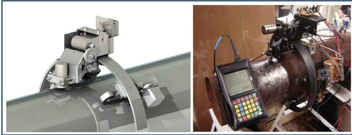
Figura 24 - Desenho em CAD à esquerda e protótipo fabricado à direita.
