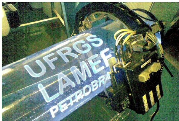
Figura 44 – Robô Inspetor em duto de acrílico.
