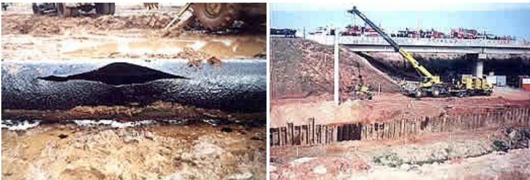
Figura 7 - Oleoduto rompido por corrosão em Campinas, 1990. Rompimento do gasoduto (GLP) por ação de terceiros, Barueri, 2001.
