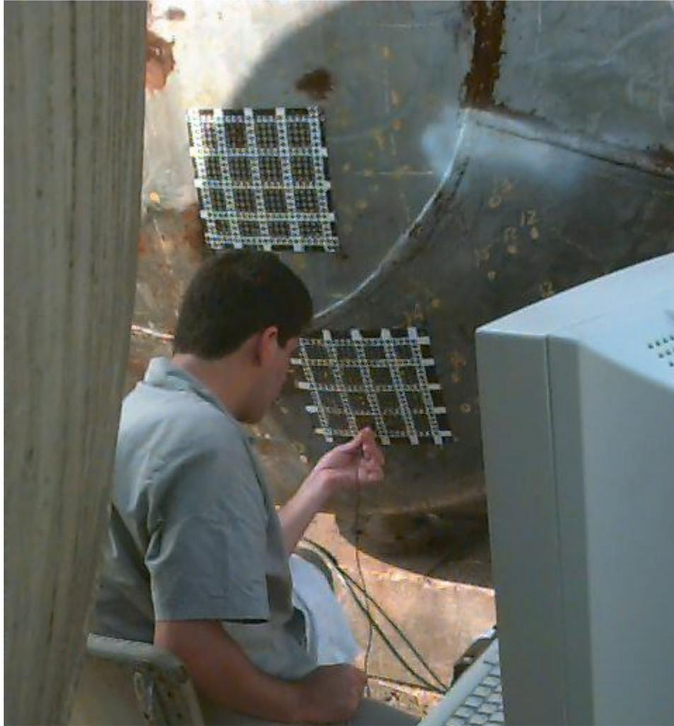
Figura 14 - Coleta de ecogramas de ultrassom com varredura manual.
