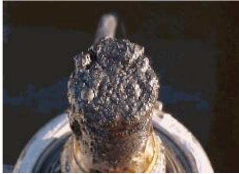
Figura 6 - Resíduo e condensado sobre cupom de corrosão retirado de um duto
