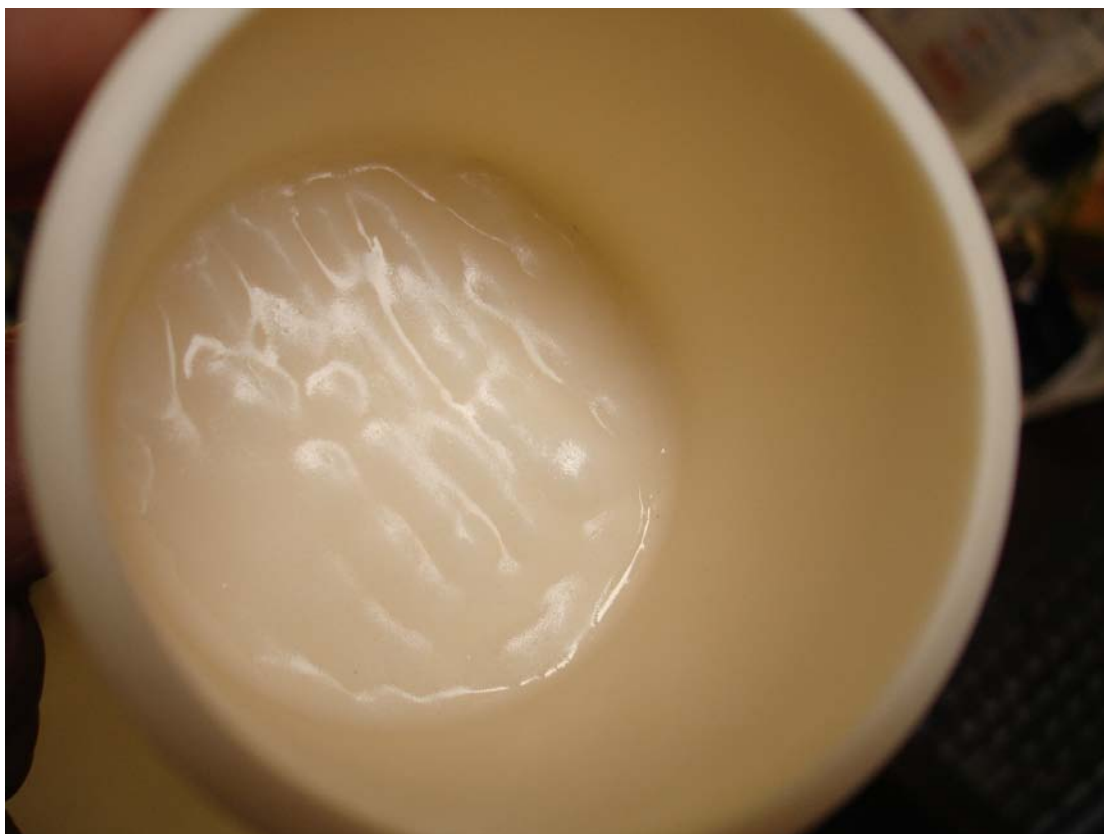
Figura 7.2 – Aspecto do inibidor fosfato ácido de alumínio após tratamento a 1200°C durante 15min.
