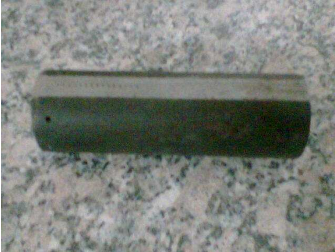
Figura 4.15 Corpo de prova usinado para ensaio de dureza
