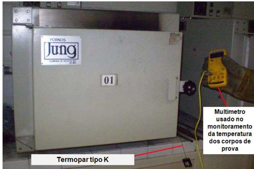
Figura 4.7 Forno tipo Mufla utilizado para os tratamentos de normalização
