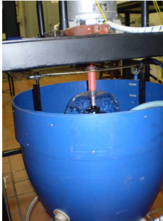
Figura 4.2 Dispositivo para Ensaio Jominy. [Laboratório de Metalografia - LAMETT – PUCRS]
