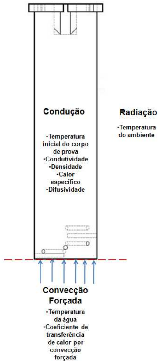
Figura 3.30 Mecanismos de transferência de calor durante o ensaio
