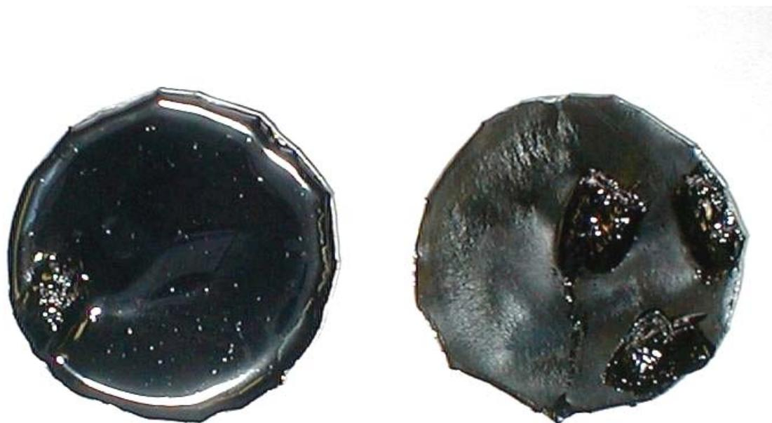
Figura 28: Fotografia do corpo de prova do ligante asfáltico BRA antes (a) e depois (b) efeito exposição aos raios UV.
