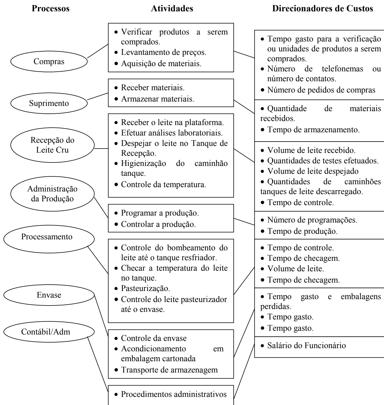
Figura 38 – Identificação dos direcionadores de custos na planta de processamento
