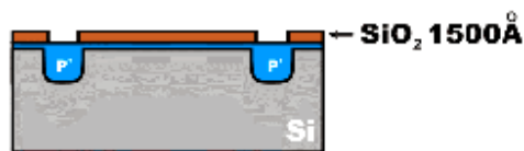
Figura 3.12: Rebaixamento do óxido à 1500Å.
