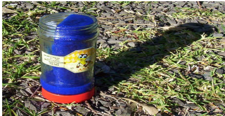
figura 31. um dos potes utilizados com líquido congelado, note que o grupo que o utilizou não usou corante preto, o qual seria o ideal para a absorção máxima da radiação do Sol
