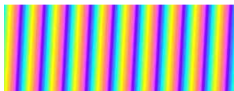
Figura 4.5: Dados ERS – interferograma sintético da fase devida à forma elipsóidica da Terra.
