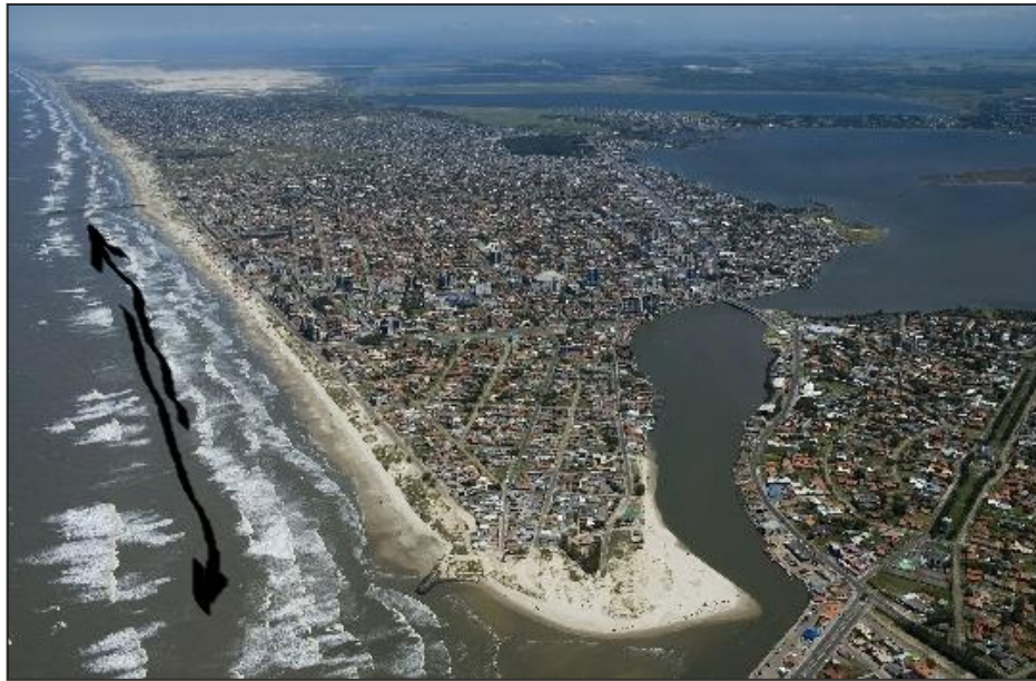
Figura 9. Foto aérea do canal de Tramandaí, mostrando que o transporte longitudinal de sedimentos pode ser para um sentido ou outro. Vê-se deposição na área clara. Fonte: Prefeitura de Tramandaí.
