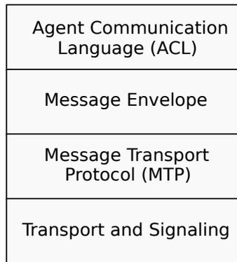
Figura 12: Camadas de comunicação utilizadas entre os agentes (TILAB, 2012).
