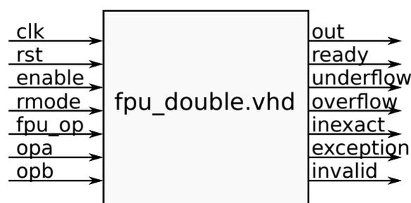
Figura 46: Arquitetura topo do módulo FPU.
