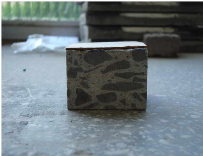
Figura 61 – Vista geral do corpo-de-prova preparado para ensaio de abrasão.
