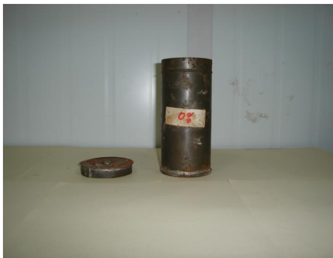
Figura 21 – Recipiente metálico para o ensaio de temperatura de hidratação de pastas com diferentes teores de adição de cinzas.
