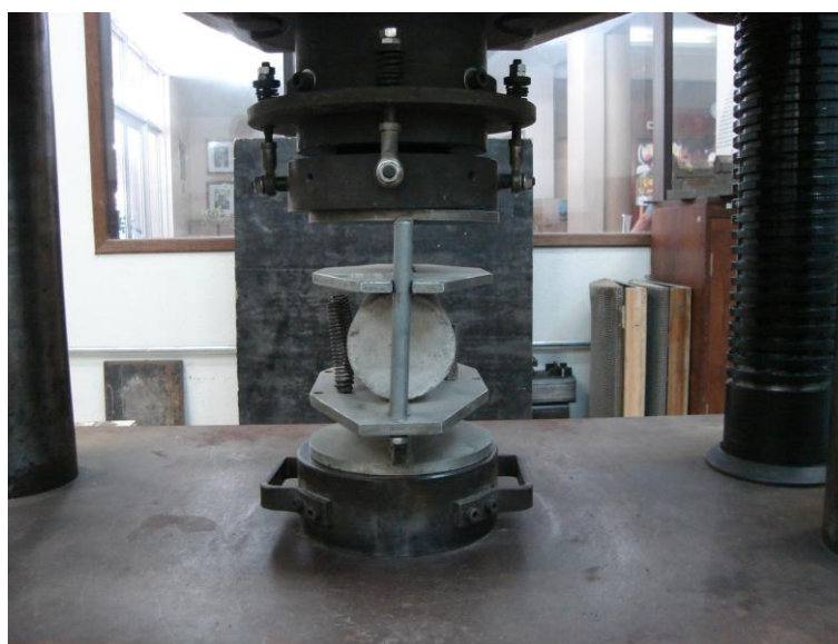
Figura 58 – Ensaio de corpo-de-prova à tração por compressão diametral.
