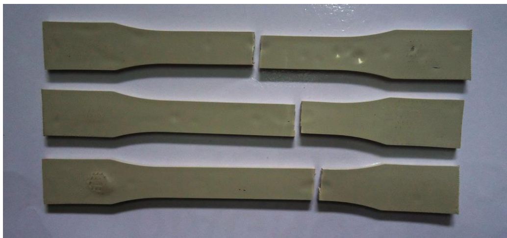
Figura 32: Corpo de prova da amostra injetada segundo a norma ASTM D638-08 após ensaio de tração.
