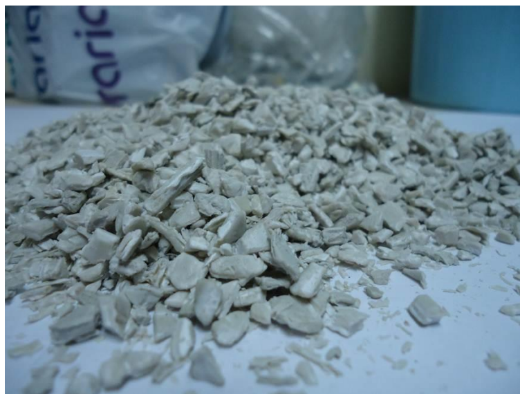
Figura 21: Exemplo de material obtido na moagem para obtenção dos corpos de prova para ensaios.
