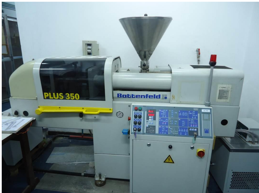
Figura 14: Injetora marca Battenfeld Plus 350 utilizada no processo de injeção dos materiais, com temperatura de 200 °C e 50 Bar de pressão.
