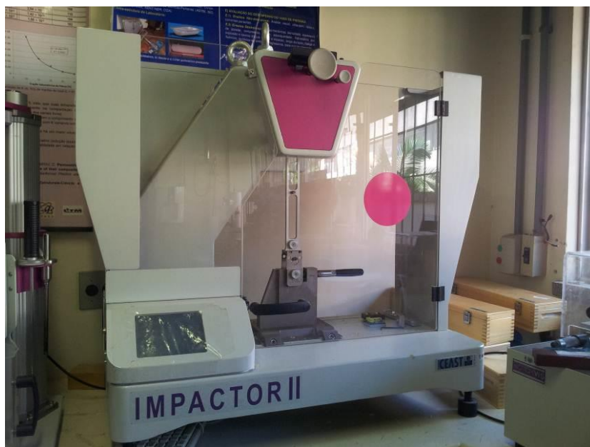
Figura 18: Equipamento para ensaio de Impacto, marca Ceast, modelo Impactor II, realizado de acordo com a norma ASTM D256-06 (2009).
