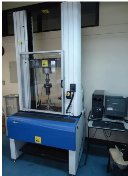
Figura 20: Equipamento utilizado para ensaio de Flexão, marca Instron, modelo 3369, realizado de acordo com a norma ASTM D-790-10 (2011).
