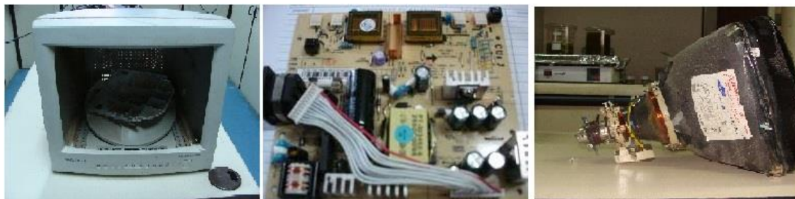
Figura 10: Componentes encontrados na desmontagem de um monitor: (a) Carcaça polimérica, (b) placa de circuito impresso e (c) tubo de raio catódico.
