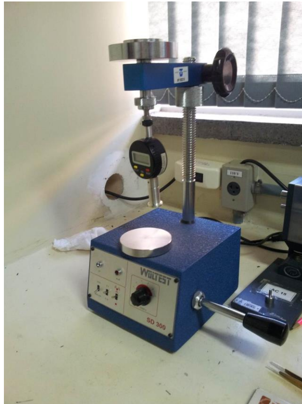
Figura 17: Equipamento utilizado para o ensaio de Dureza, Marca Woltest Sd 300, seguindo a norma ASTM D2240-05 (2010).
