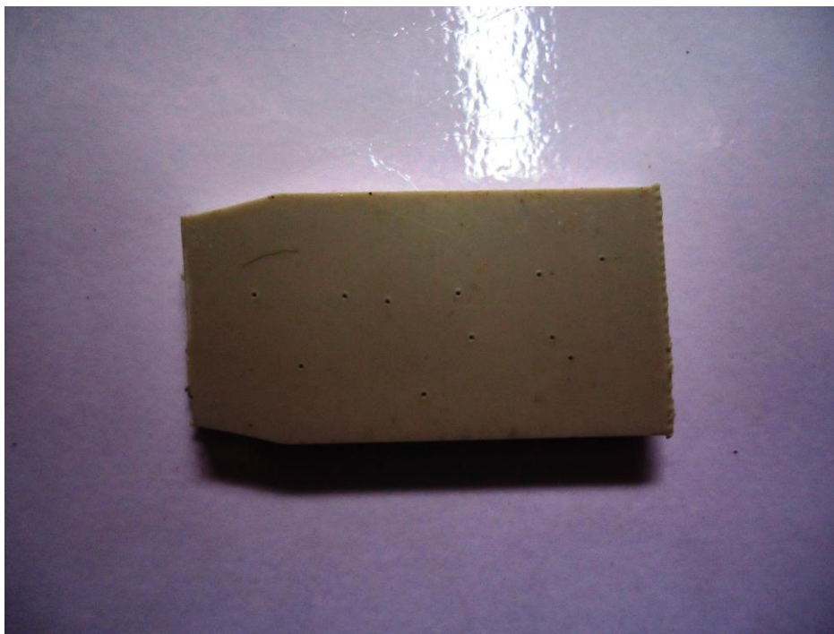
Figura 26: Exemplo de amostra utilizada no ensaio de dureza, onde é possível perceber os pontos penetrados pelo identador.
