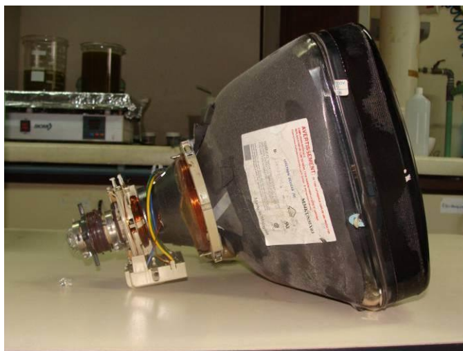
Figura 4: Tubo de imagem encontrado no interior de um monitor CRT.
