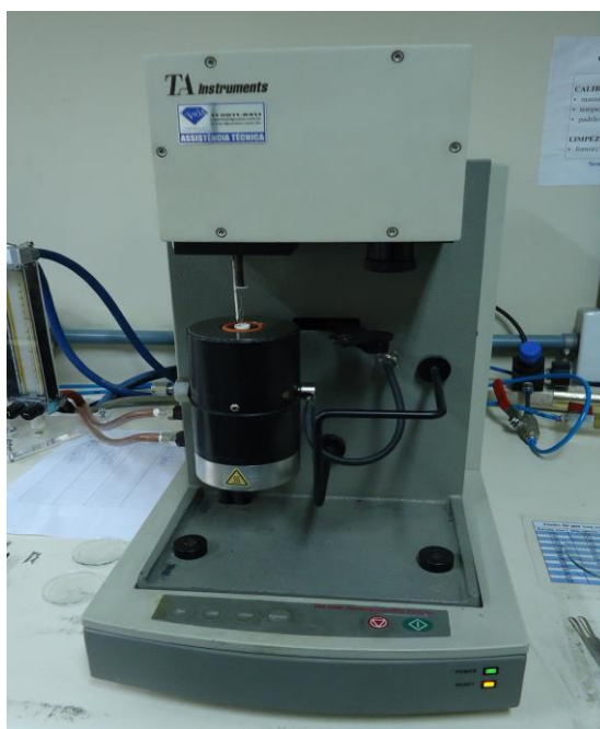
Figura 15: Equipamento marca TA Instruments e modelo TGA 2050, utilizado para análise de TGA utilizado na caracterização dos materiais
