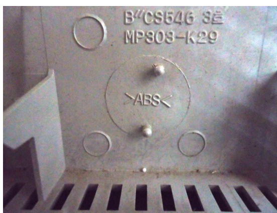
Figura 11: Símbolo do ABS (Acrilonitrila Butadieno Estireno) encontrado no interior da carcaça polimérica dos monitores CRTs
