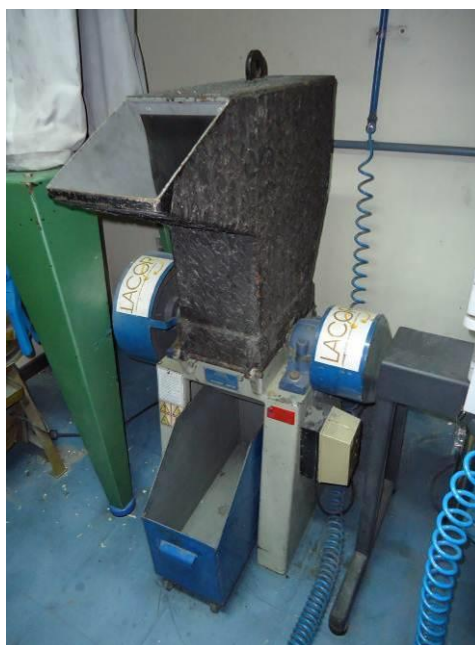
Figura 13: Moinho de facas marca Rone modelo SRB 2305, utilizado no processo de reciclagem das carcaças poliméricas dos monitores CRTs.
