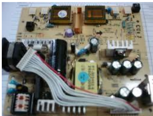
Figura 6: Placa de Circuito Impresso encontrada no interior de um monitor CRT.
