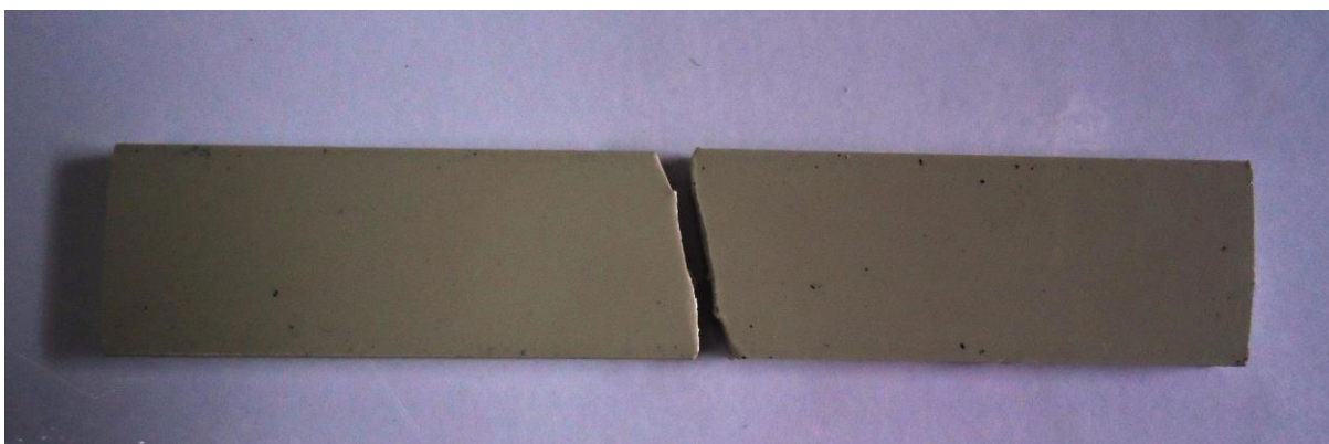
Figura 28: Exemplo de amostra utilizada no ensaio de impacto, onde é possível perceber a fratura do corpo de prova.
